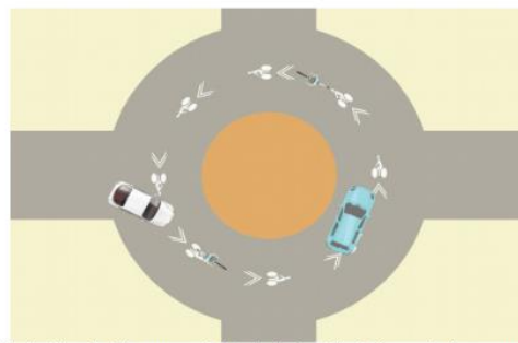
Illustration 3: Marquage de trajectoire vélo à l'axe de l'anneau du giratoire
